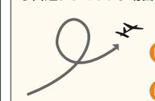
水平尾翼のうしろのへりを下げる。
