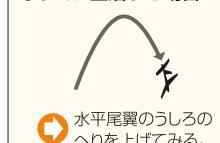
水平尾翼のうしろのへりを上げてみる。
